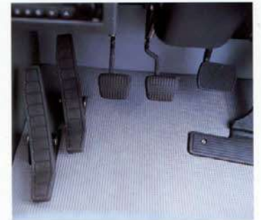
操作しやすい最適配置のペダル 幅広の足踏みペダルを採用。 (写真は自由降下装置付仕様)
