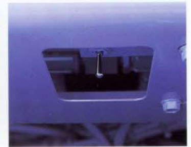
パワーウィンドウ閉め忘れ外 部スイッチをキャブ下に装備
